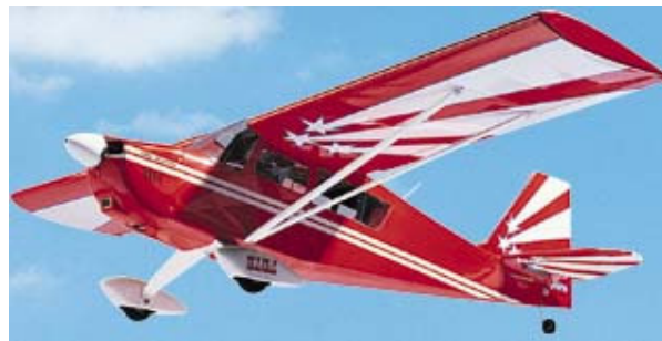
Avión Acrobático Súper Decatlón con tren de patín de cola.
